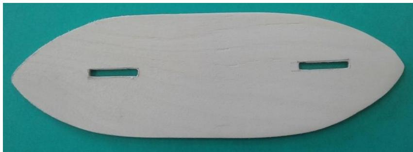
После того как детали выпилены, зачищают вырезанные участки заготовки шлифовальной шкуркой или надфилями. Надфили – это небольшие напильники с мелкой насечкой. Они имеют различные профили в поперечном сечении.
