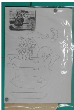
На копировальную бумагу положить чертеж, на чертеж прозрачную кальку. Она практически не изнашивается и может быть использована многократно. Всё скрепить кнопками. Теперь можно перенести линии чертежа с помощью кальки, ручки или мягкого карандаша на деревянную поверхность. При этом контуры и внутренние линии чертежа
