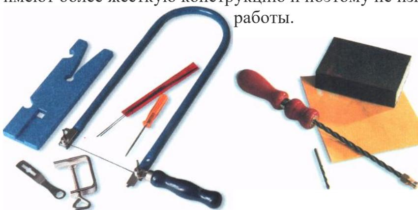
Купите сразу много пилок, так как иногда она рвется и подлежит замене. Чтобы закрепить пилку в лобзике, отвинтите барабанковые винты, которые расположены сверху и снизу на лобзике. Винты часто бывают очень крепко закручены, поэтому используйте ключ для барабанковых винтов. Теперь вставьте новую пилку в зажимы. При этом зубчики должны оказаться снаружи и указывать вниз. Затем снова закрутите винты.
