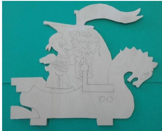
Сначала мы выпилим сам кораблик с утенком. Положите дощечку с нанесенными контурами рисунка на столик для выпиливания. При выпиливании ведите лобзик равномерными движениями вперед-назад с легким нажимом. При этом держите лобзик по возможности горизонтально.
