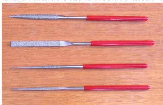
Для зачистки ребер, отверстий и внешних контуров, выпиленного изделия потребуются небольшие напильники со средней насечкой (личные). Напильников желательно иметь три: плоский, полукруглый или трехгранный и круглый.
